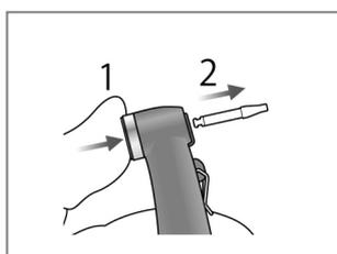
(5) Ziehen Sie die Schraube sicher fest und drücken Sie dann den Auslöseknopf, um das Führungswerkzeug herauszuziehen.
