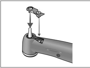
6. Schieben Sie die interne Elektrode auf das Führungswerkzeug und richten sie die Löcher für die Schraube aus.
