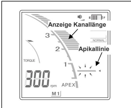
Die aktuelle Position der Feilenspitze wird auf der Balkenanzeige für die Kanallänge gezeigt. Die Apikal-linie blinkt, sobald die Feile in den Wurzelkanal eingeführt ist.
