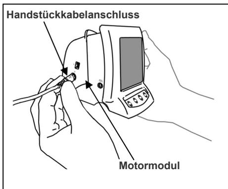
1. Richten Sie den Pfeil am Stecker des Handstückkabels auf das schmale Dreieck oberhalb seiner Buchse aus und stecken Sie es so weit hinein, bis der Pfeil in der Buchse verschwindet.
