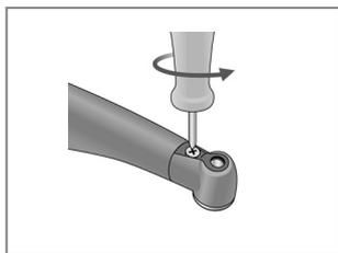
1. Lösen Sie die Schraube und entfernen Sie die interne Elektrode.
