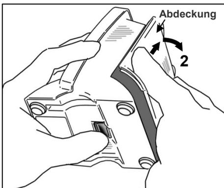
2. Schieben Sie die Batterieabdeckung gemäß Abbildung in Pfeilrichtung und nehmen Sie sie vom Apex Lokator.
