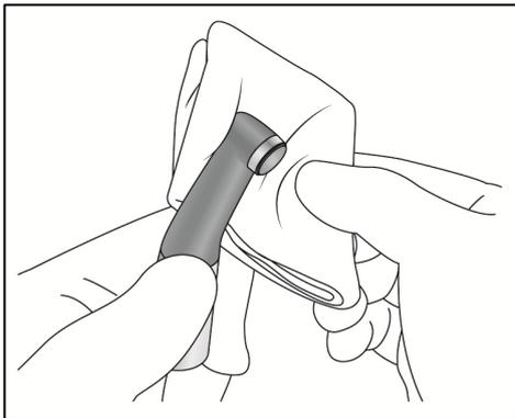
Wischen Sie die Bauteile mit einem in Desinfektionsalkohol (Ethanol 70 vol% bis 80 vol%) getränkten Stück Gaze ab.
