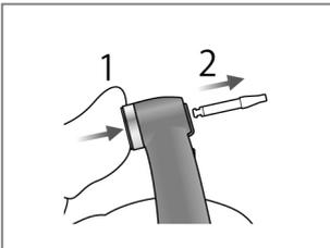
8. Ziehen Sie die Schraube sicher fest und drücken Sie dann den Auslöseknopf, um das Führungswerkzeug herauszuziehen.
