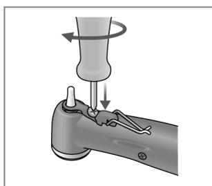
(4) Drehen Sie die Schraube langsam und stellen Sie sicher, dass die Kappe richtig eingeführt wird.
