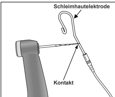
6. Berühren Sie die Feile mit der Schleimhautelektrode und überprüfen Sie, ob alle Kanallängenanzeigebalken angezeigt werden, ob das Wort „APEX“ blinkt und ein hörbarer Piepton zum Dauerton wird. Seien Sie beim Berühren der Feile mit der Schleimhautelektrode vorsichtig, weil die Feile sofort zu rotieren beginnt, sobald die Feile die Schleimhautelektrode berührt.
