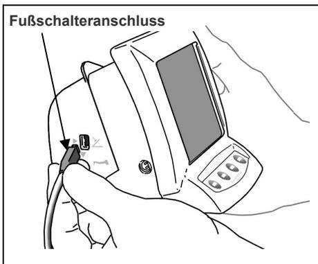
Stecken Sie den Fußschalterstecker vollständig in seine Buchse auf der Seite des Motormoduls [Diese Buchse ist mit einem kleinen nach rechts zeigenden Dreieck gekennzeichnet.]
