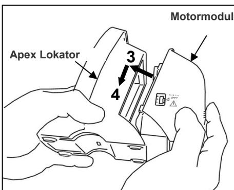
3. Verbinden Sie die Nasen des Motormoduls mit den Aussparungen im Apex Lokator und setzen Sie die beiden Module zusammen.
