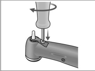
7. Drehen Sie die Schraube langsam und stellen Sie sicher, dass die interne Elektrode richtig eingeführt wird.
