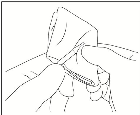
Wischen Sie das Bauteil mit einem mit Desinfektionsalkohol (Ethanol 70 bis 80 vol%) befeuchteten und ausgewringenen Stück Gaze ab.
