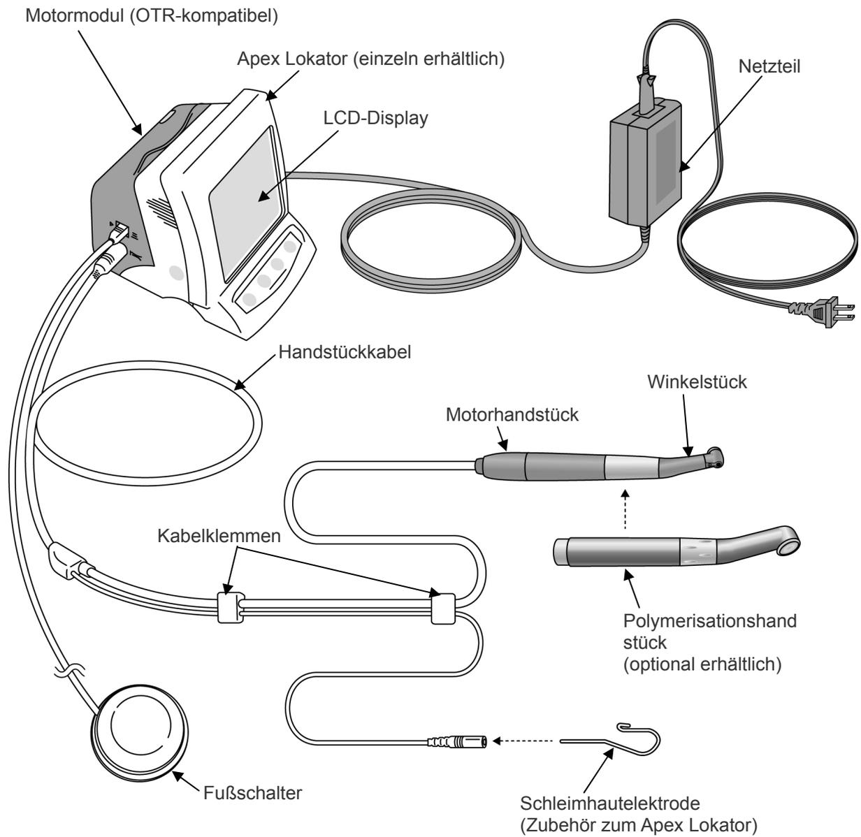
\* Verbinden Sie das Motormodul mit dem Apex Lokator.
