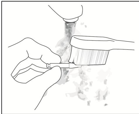
Entfernen Sie die Bohrrückstände unter fließendem Wasser mit einer weichen Bürste und wischen Sie dann das restliche Wasser ab.
