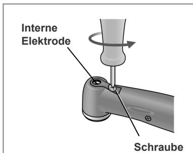
(1) Lösen Sie die Schraube und entfernen Sie die interne Elektrode.
