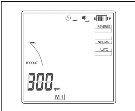
Wenn der Fußschalter betätigt wird, läuft der Motor in der eingestellten Geschwindigkeit. (Wenn die Feile sich außerhalb des Kanals befindet, verschwindet die Messanzeige.)
