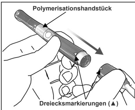
1. Richten Sie die Dreiecksmarkierungen am Handstückkabel am Polymerisationshandstück aus und stecken Sie es vollständig auf.
