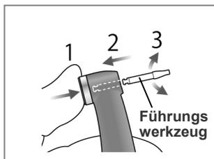
(2) Halten Sie den Auslöseknopf und führen Sie das Führungswerkzeug gerade ein wie in der Abbildung dargestellt. Drehen Sie es dann nach links und rechts.
