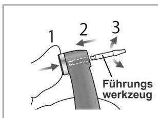
5. Halten Sie den Auslöseknopf und führen Sie das Führungswerkzeug gerade ein wie in der Abbildung dargestellt. Drehen Sie es dann nach links und rechts.
