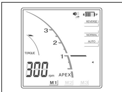
Drücken Sie die Taste MODE zur Auswahl von M1, M2, oder M3 und führen Sie die Wurzelkanalaufbereitung durch.
