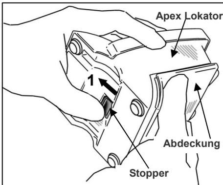
1. Halten Sie die Batterieabdeckung fest und schieben Sie die Entriegelung auf dem Boden in Richtung der LCD-Anzeige.
