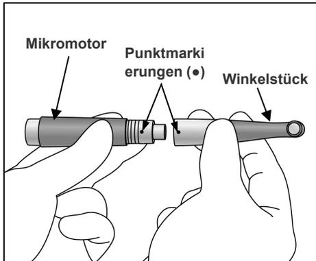
1. Richten Sie die Punkte am Motorhandstück und am Winkelstück aufeinander aus und schieben Sie das Winkelstück gerade auf das Motorhandstück bis es sicher einrastet. Das Winkelstück besitzt eine einfache Schnappverbindung.
