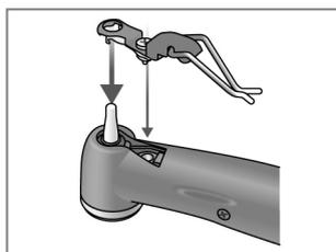
(3) Schieben Sie die Kappe mit der Elektrode auf das Führungswerkzeug und richten sie die Löcher für die Schraube aus.
