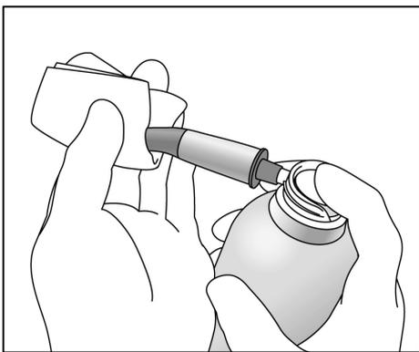
2. Setzen Sie die Düse auf die Spraydose auf. Sprühen Sie nun 2 Sekunden lang Spray durch das Verbindungsende in das Winkelstück. Überschüssiges Spray von der Außenseite des Winkelstücks abwischen.
