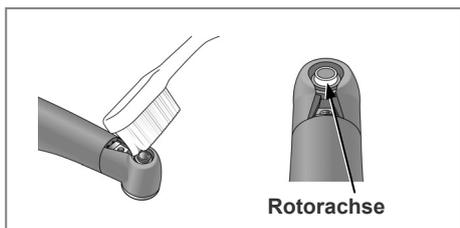
2. Geben Sie etwas Desinfektionsalkohol (Ethanol 70 vol% - 80 vol%) auf eine kleine Bürste und reinigen Sie die Rotorachse damit.
