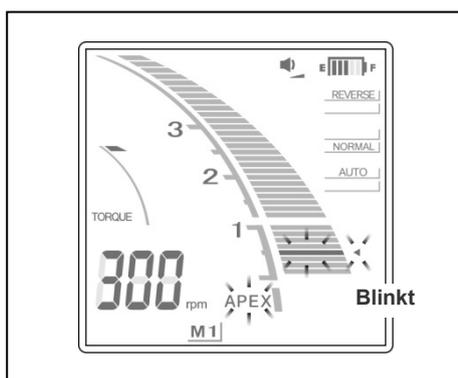
Wenn die Feilenspitze die durch die Apikallinie gekennzeichnete Position überschreitet, ändert sich der Alarmton vom Piepen in einen Dauerton. Wenn die Feilenspitze das eigentliche Foramen erreicht, ändert sich der Alarmton in einen anhaltenden Piepton und das Wort "APEX" und das kleine Dreieck neben der Apikallinie beginnen zu blinken.
