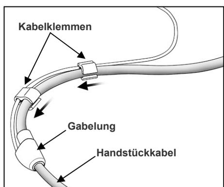
2. Rutschen Sie die Kabelklemmen einzeln zu dem Punkt hinunter, an dem sich die Kabel gabeln, so dass sie nicht im Weg sind, wenn Sie das Kabel der Schleimhautelektrode verwenden wollen.
