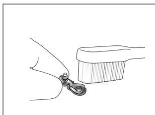
3. Reinigen Sie die interne Elektrode mit einer kleinen Bürste.
