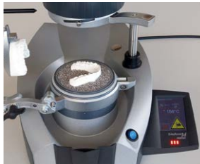
8. Achtung , der automatisierte Tiefziehvorgang beginnt. Quetschgefahr!
