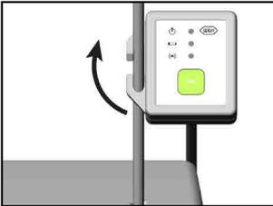
❷ Fixez le dongle SPI à la potence ou déconnectez le dongle SPI de la potence.
