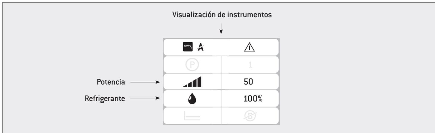
El rango de potencia se puede ajustar entre 5 y 70.
