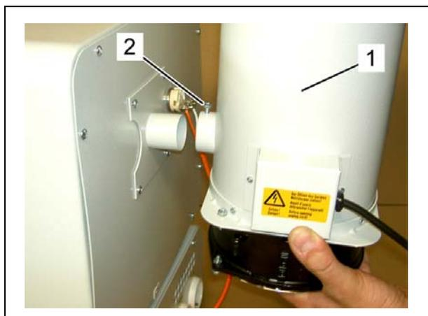
Schéma 6: Monter le catalyseur KN2
