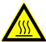
**Pericolo dovuto alle elevate temperature nella cappa del catalizzatore durante l'utilizzo dell'apparecchio (ca. 600°C)!**
