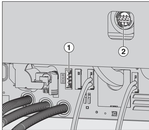
① Anschluss Stromversorgung DOS 1 Reiniger.
