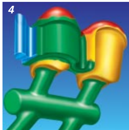
Fig. 4,5: Jetzt erfolgen die normalen Arbeitsgänge: Einbetten, Gießen, Ausarbeiten.
