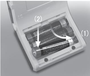
(1) Setzen Sie die Batterien ein, indem Sie die Mitte des Minuspols gegen den Federkontakt drücken.
