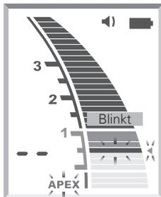
Die Position der Feilenspitze wird vom Kanallängen-Anzeigebalken auf der Anzeige angezeigt. Die Balkenanzeige blinkt, sobald die Feile in den Wurzelkanal eingeführt wird.
