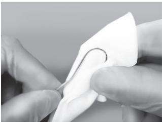
Wischen Sie den (langen) Feilhalter und die Schleimhautelektrode mit einem in Desinfektionsalkohol (Ethanol 70 bis 80 vol%) getränkten Stück Gaze ab.
