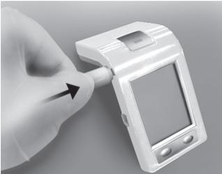
1. Stecken Sie das Messkabel sicher in die Buchse auf der linken Seite des Root ZX mini.
