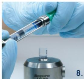
**8.-8d.** Die Injektionsnadel wird nunmehr vom Spitzenkopf abgedreht - in die Schutzkappe eingeführt und danach sicher entnommen.
