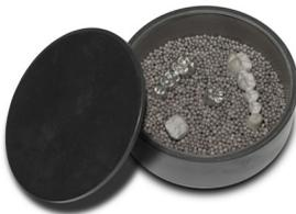
1. Llene la cubeta de sinterización con un paquete de perlas de sinterización (un paquete de perlas de sinterización ~ aprox. 280 g).
