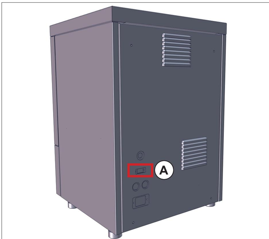
Abb. 4: Interfaccia RS-232 (esempio)
