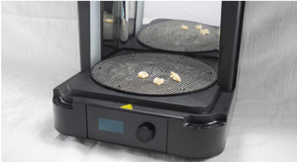
Für beste Ergebnisse und volle Konformität müssen die Druckteile wie empfohlen zwei Mal nachgehärtet werden.
