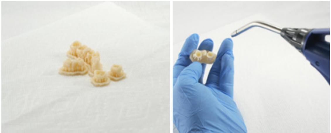
Sollte nach dem Trocknen noch feuchtes, ungehärtetes Harz verbleiben, verwenden Sie eine Druckflasche mit frischem IPA, um dieses zu entfernen. Trocknen Sie das Teil anschließend abermals an der Luft.
