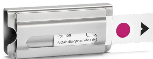
Wash-Sensor U Indikatorplättchen seitlich von rechts und mit der Testanschmutzung nach vorne bzw. oben gerichtet bis zur Markierung in die Wash-Sensor Halterung einschieben.
