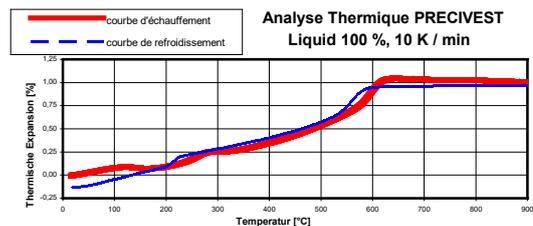
L'utilisation du liquide haute expansion réf. 931-2000 est recommandée pour les alliages non précieux. 80% de liquide haute expansion additionnés de 20% d'eau distillée augmentent de 0,50% l'expansion de prise du YETIVEST équivalant approximativement aux 100% de liquide standard pur.
