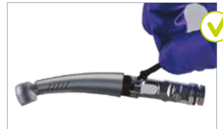
Wechsel eines Wasserfilters
